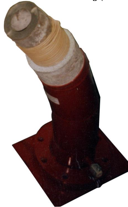
Rohrbogen mit Schmelzbasalt oder Keramik-Innenrohr und Überwachung (Drahtbruch)
